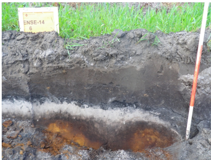
Afb. 4. De bodemopbouw in tracédeel B.
